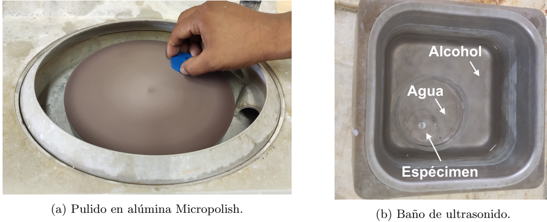
Figura 5.15: Pulido y baño de especímenes de acero.
